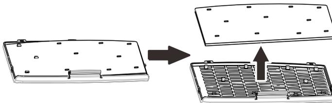
3. Setzen Sie ein neues Filtermodul ein oder bringen Sie die Abdeckung wieder am Filter an.
