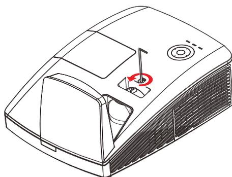
Drehen Sie die Regler zum Versetzen des Projektionsbildes nach oben gegen den Uhrzeigersinn.
