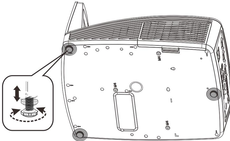
Zur Anpassung des Projektionswinkels drehen Sie den Neigungsregler im oder gegen den Uhrzeigersinn, bis der gewünschte Winkel erreicht ist.
