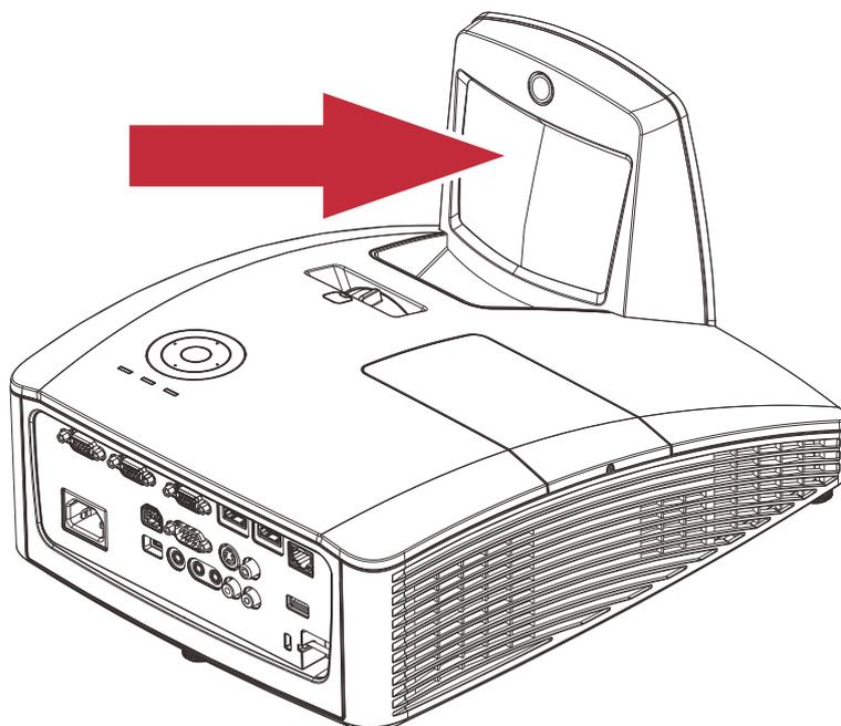
Entfernen Sie Staub mit einem im Fotofachhandel erhältlichen Objektivpinsel mit Blasebalg, damit der Spiegel nicht durch mehrmaliges Wischen verkratzt wird.
