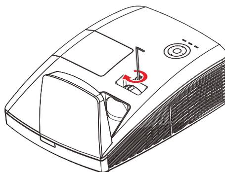
Drehen Sie die Regler zum Versetzen des Projektionsbildes nach unten im Uhrzeigersinn.
