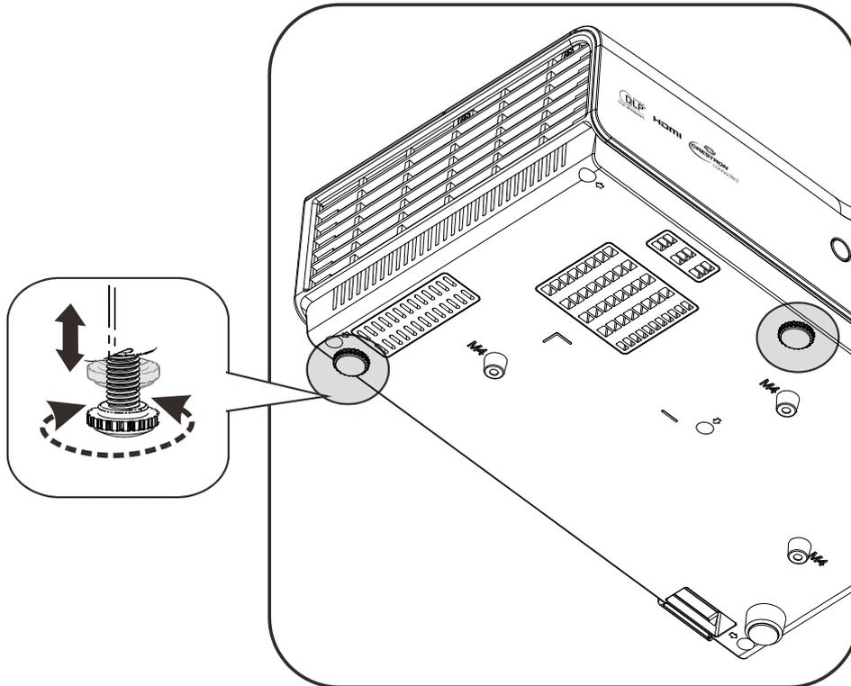
Zur Anpassung des Projektionswinkels drehen Sie den Neigungsregler im oder gegen den Uhrzeigersinn, bis der gewünschte Winkel erreicht ist.
