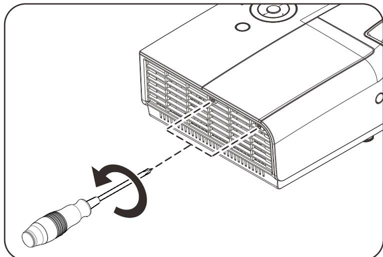
2. Entfernen Sie die Abdeckung des Lampenfachs.
