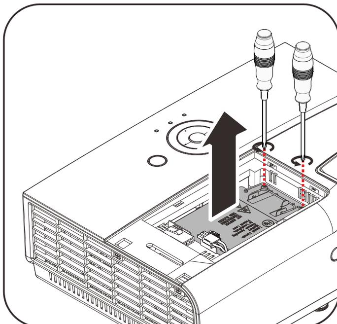
7. Befolgen Sie zur Installation des neuen Lampenmoduls die Schritt 1 bis 6 in umgekehrter Reihenfolge. Richten Sie bei der Installation das Lampenmodul aus; achten Sie zur Vermeidung von Schäden darauf, dass es gerade ist.
