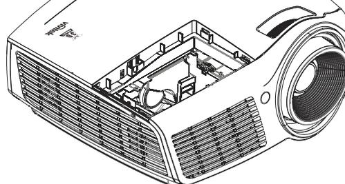
5. Puxe firmemente pela pega do módulo para remover o módulo da lâmpada.
