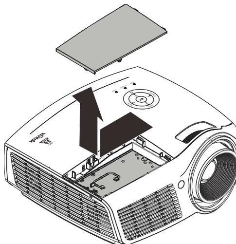
3. Retire os três parafusos do módulo da lâmpada.
