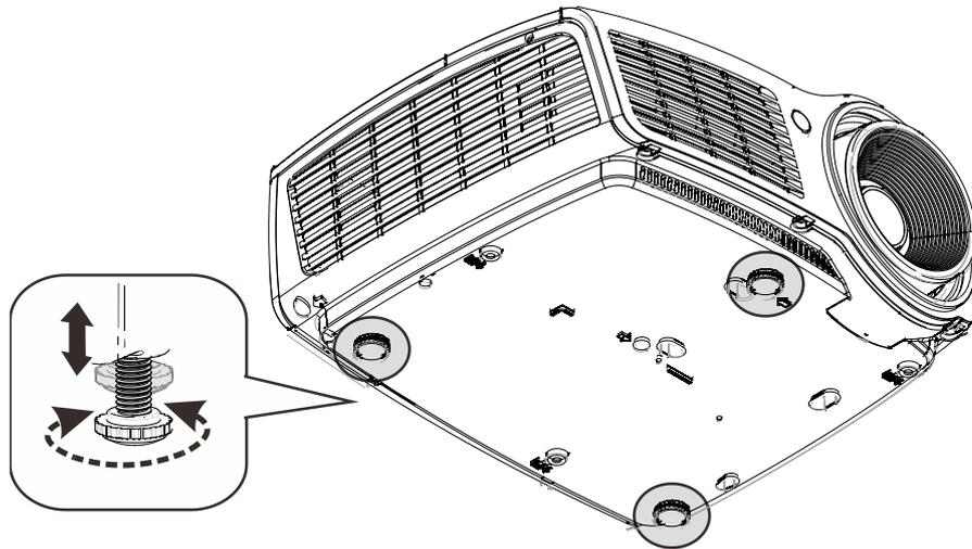
Zur Anpassung des Projektionswinkels drehen Sie den Neigungsregler im oder gegen den Uhrzeigersinn, bis der gewünschte Winkel erreicht ist.
