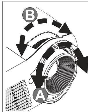
2. Stellen Sie das projizierte Bild mit Hilfe des **Bildfokusreglers** (nur am Projektor) scharf **A**.
