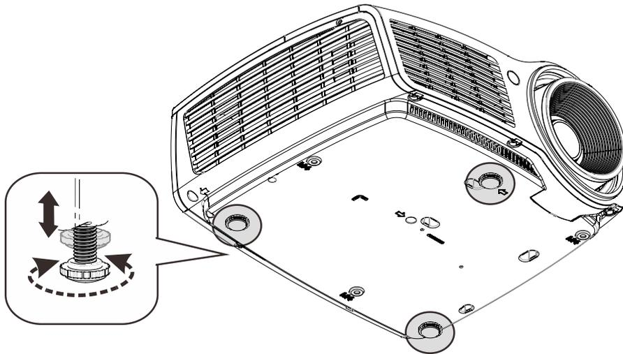
Pour régler l'angle de l'image, tournez le régulateur d'angle vers la droite ou la gauche jusqu'à obtenir l'angle désiré.
