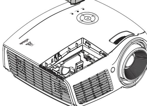
5. Tirez fermement sur la poignée du module pour retirer le module de la lampe.
