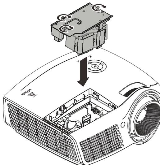
**Remarque :** Le module de lampe doit être parfaitement mis en place et le connecteur de la lampe doit être connecté correctement avant de serrer les vis.
